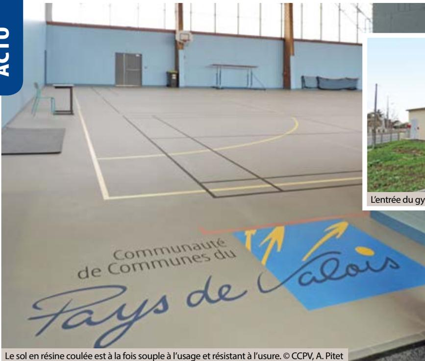
Le sol en résine coulée est à la fois souple à l'usage et résistant à l'usure. © CCPV, A. Pitet
