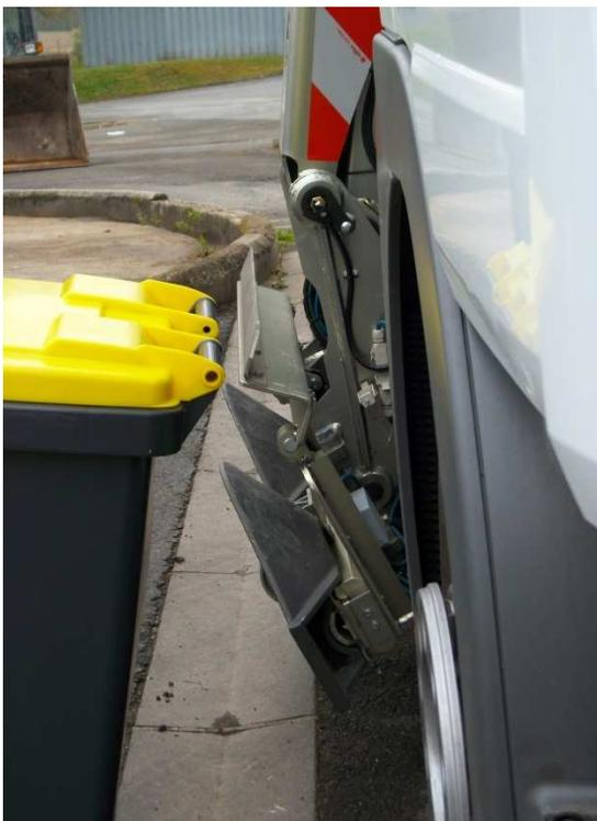
La préhension des bacs avec la pointe diamant est moins exigeante au niveau du positionnement des bacs par rapport à la technique du simple peigne grâce au centrage automatique de la ou des poubelle(s)
