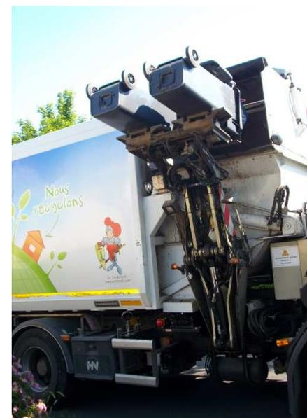
Les couvercles des bacs s'ouvrent sous l'effet de la gravité et leur contenu verse dans la trémie
