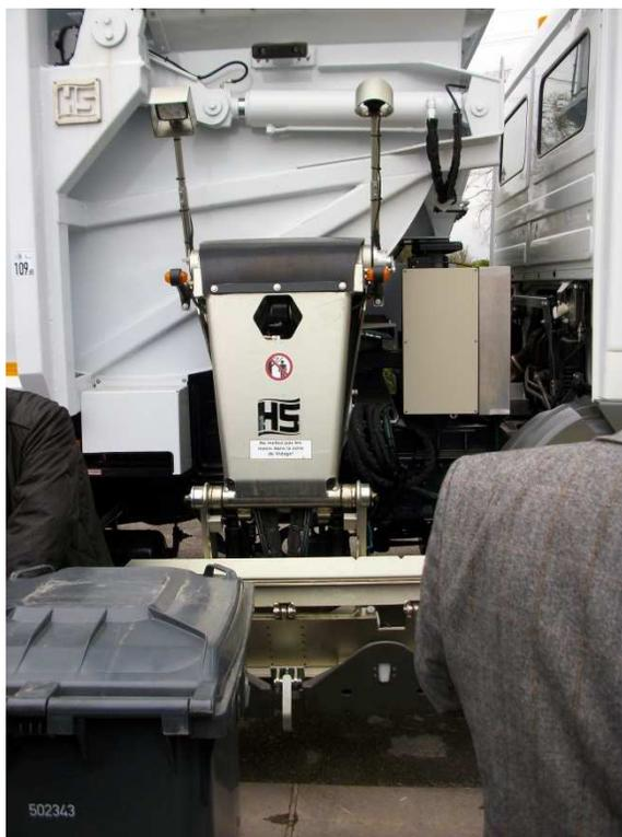
Préhension avec 2 pointes permettant de lever 1 ou 2 bacs ; les bacs sont revêtus d'une **collerette**. Cette technique garantit plus de stabilité du bac lors de sa levée, de son vidage et de sa repose au sol.
