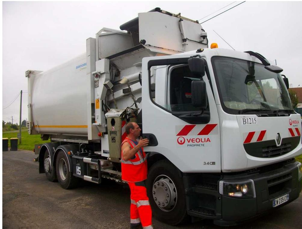
Avec la collecte latérale robotisée, l'équipage se réduit à **1 seul chauffeur** qui devient un conducteur-opérateur autonome. Au démarrage du nouveau service, 1 ripeur l'a accompagné pour s'assurer du bon positionnement des bacs le long des voiries.
