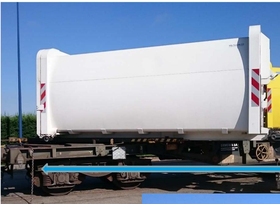
La chaîne sur la berce est tirée par le châssis pour bien positionner la benne sur le wagon
