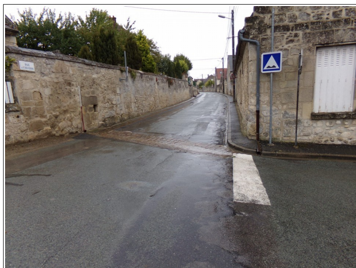
Figure III.4: carrefour des rues de la Croix Rebours et de la Dîme. La chaussée profilée envoie les écoulements en direction de la rue de la Dîme.
