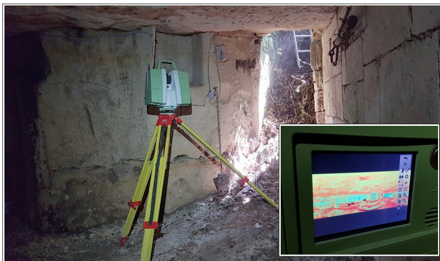
Figure III.18: scanner 3D et visionnage en direct de l'image scannée.
