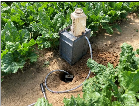
Sondage 2 + Test perméabilité
