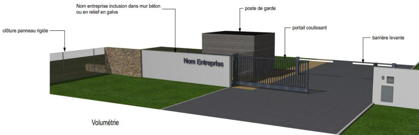
Figure 5 : Traitement des entrées
