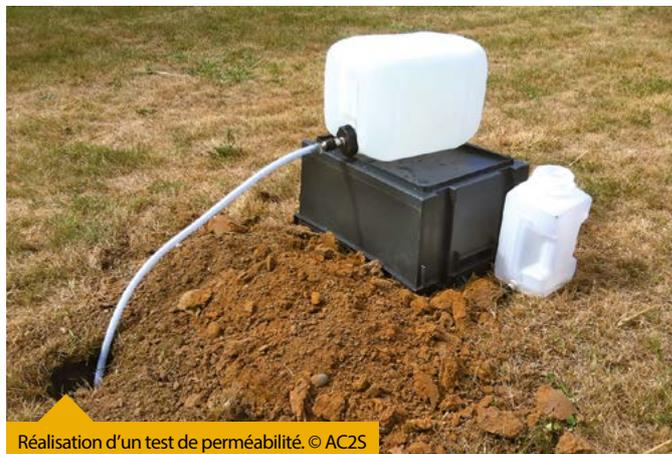
Réalisation d'un test de perméabilité. © AC2S
